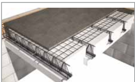
Рис. 8. Конструктивная схема перекрытия МАРКО-ТЕРМО
