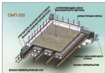
Рис. 1 Схема сборно-монолитного перекрытия МАРКО-СТАНДАРТ
