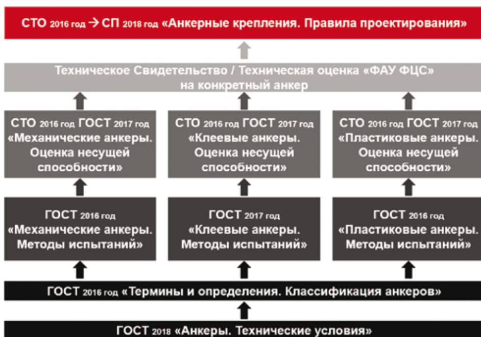
Рис. 5. Структура системы нормирования в области анкерного крепления
